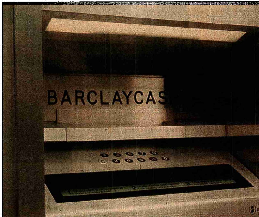
El primer cajero automático, fabricado por De La Rue para Barclays Bank en 1967.
